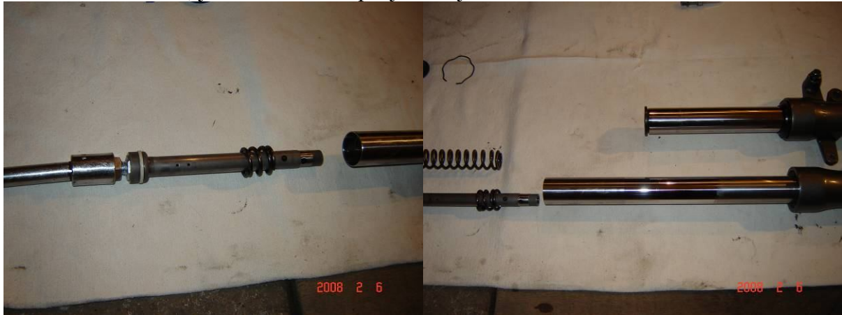
Balról a célszerszám, jobbról a teleszkóp aljából kijövő imbuszcavar.
