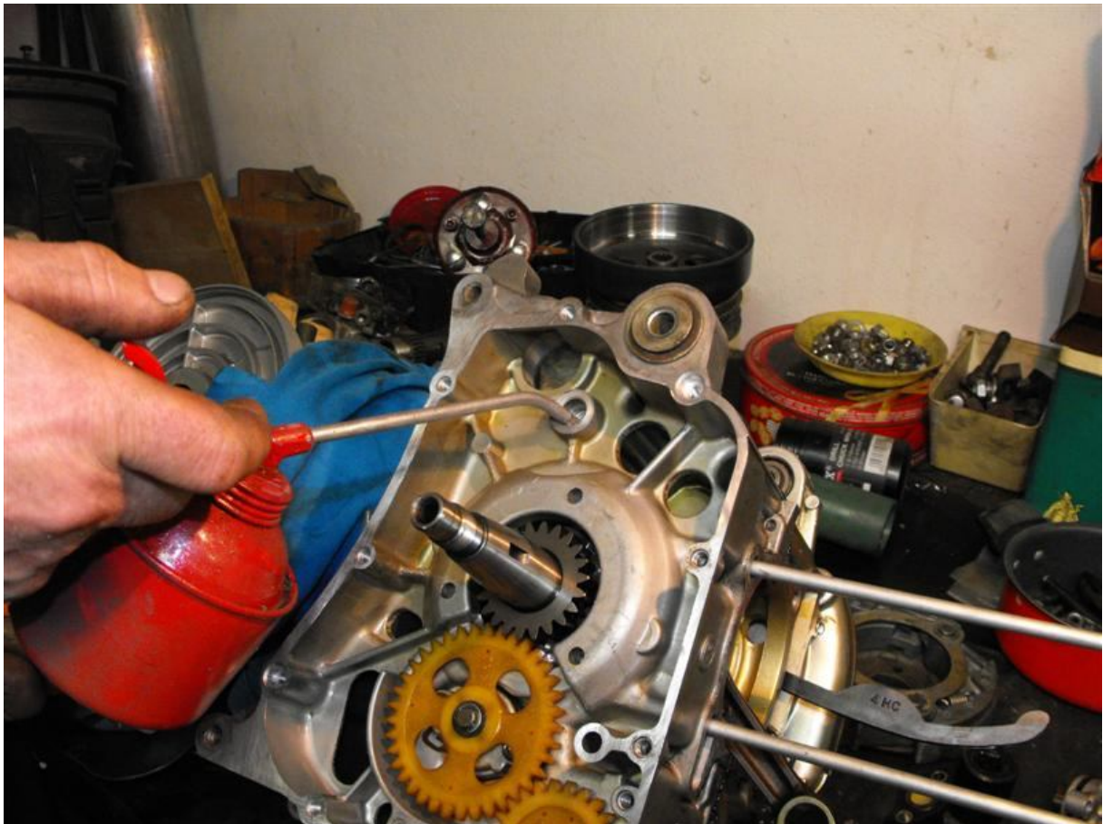
13.kép:Célszerű vékonyan megolajozni azokat helyket, ahova tengely végződés kerül majd be, valamint magukat a forgó, surlódó alkatrészeket is.Ezen a képen jól látható az a bakelit fogaskerékpár, amely innen egy tengellyel kapcsolódik a túloldalra és hajtja meg a vízpumpát
